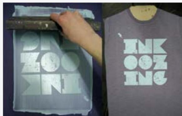
L'écran est placé sur le support et l'encre déposée sur l'écran. L'encre râclée sur l'écran traverse les mailles ouvertes.
