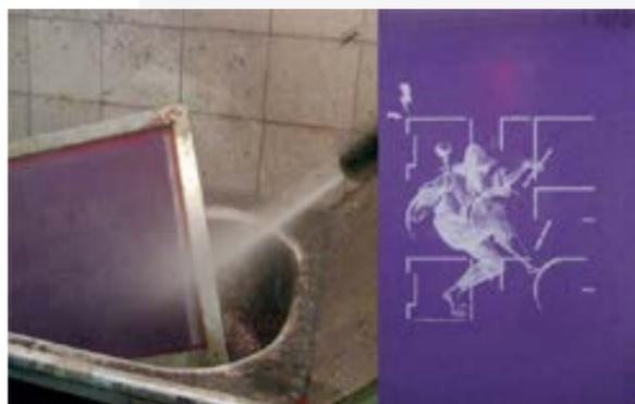
Le bouche-pore non exposé se retire sous la pression d'un jet d'eau. Les mailles s'ouvrent, formant le pochoir.
