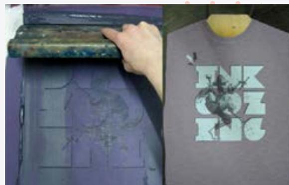
Le visuel est ainsi imprimé sur le support. On peut superposer des couches d'encre pour imprimer en plusieurs couleurs.
