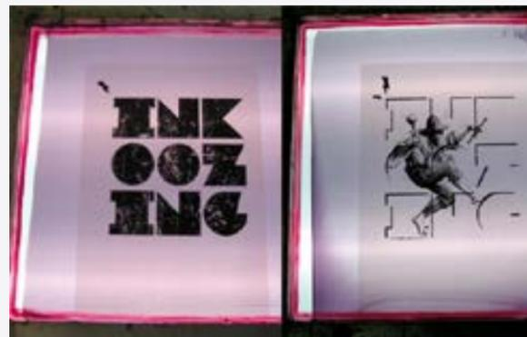
On place le typon sous l'écran puis on l'expose à la lumière. La lumière fixe le bouche-pore photosensible.
